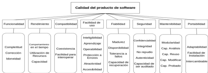
**Figura 1. Modelo de Calidad ISO/IEC 20510. Características con sus sub-características de calidad (ISO/IEC 25010, 2011)**
