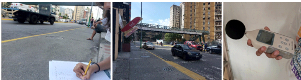
Figura 3. Punto A (a la izquierda), punto B (al centro) y el Decibelímetro utilizado (a la derecha).
